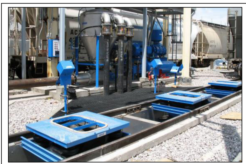
Figure 3.36 Modèle de manche de déchargement de wagon
