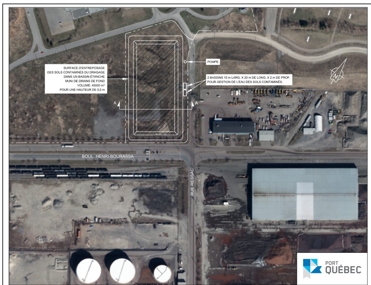
Figure 3.18b Bassin étanche pour la gestion des sédiments contaminés
