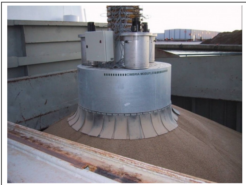
Figure 3.35 Modèle de manche télescopique pour le chargement d'un navire
