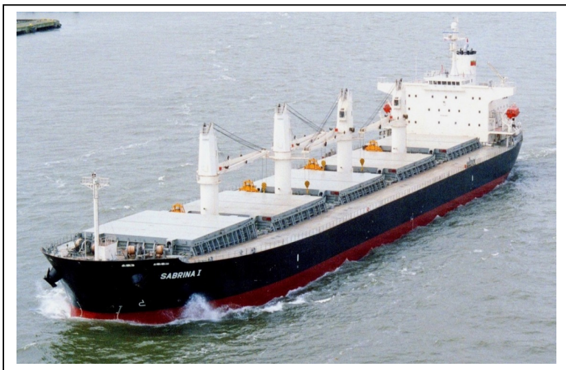
Figure 3.38 Navire muni de grues de déchargement
