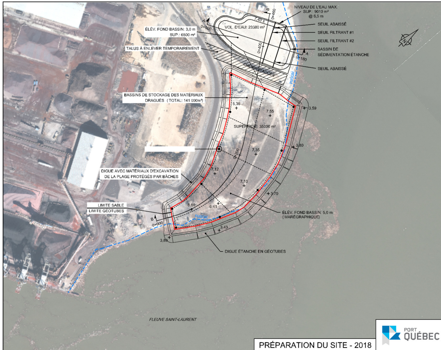
Figure 3.2 Plan d'aménagement des bassins de décantation et de sédimentation
